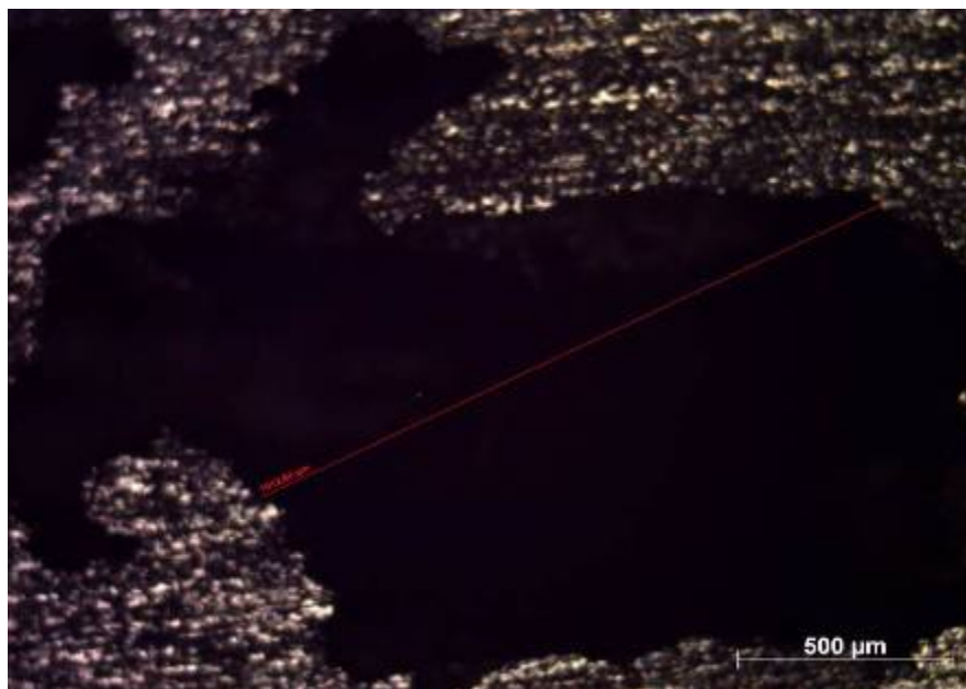
Figura 20 – Aspecto de um pite da amostra 430R.2. Tamanho aprox. 1612µm (50x)
