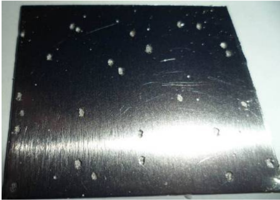
Figura 13 – Aspecto da amostra 439R.2 após ensaio
