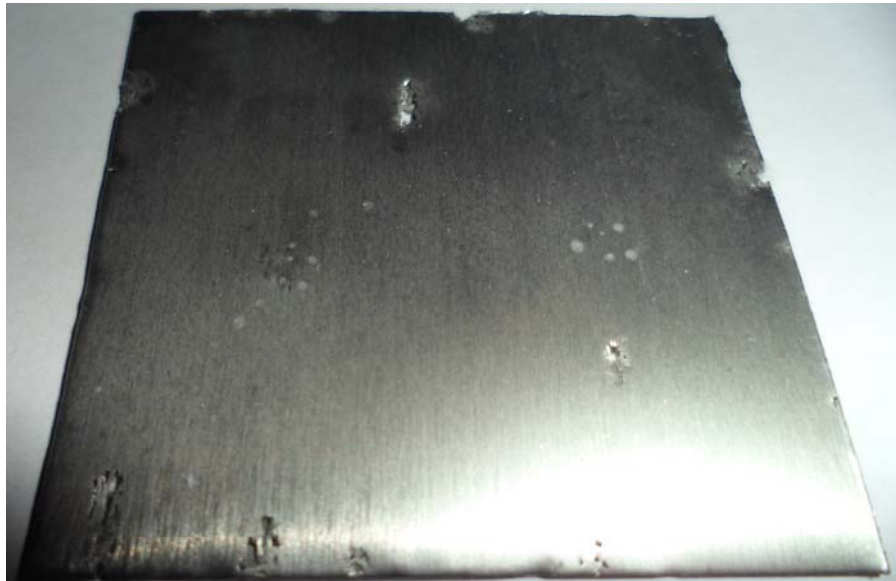
Figura 19 – Aspecto da amostra 430R.2 após ensaio
