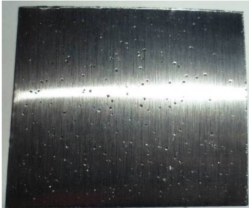
Figura 7 – Aspecto da amostra 439E.2 após ensaio
