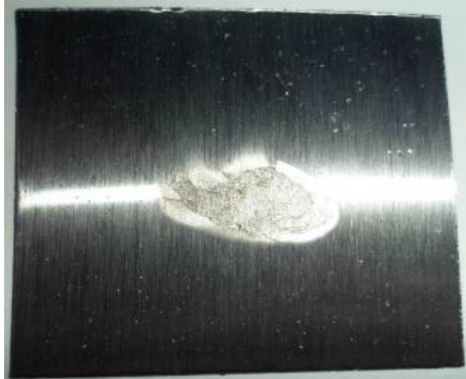
Figura 5 – Aspecto da amostra 439E.1 após ensaio
