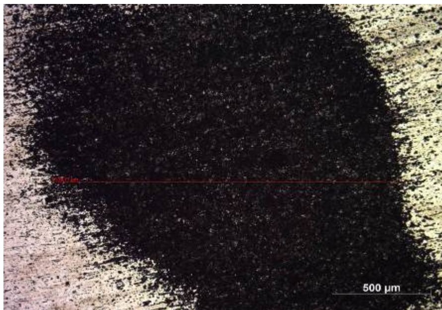
Figura 4.28 – Aspecto de um pite da amostra 430B.3. Tamanho aprox. 1736µm.(50x).
