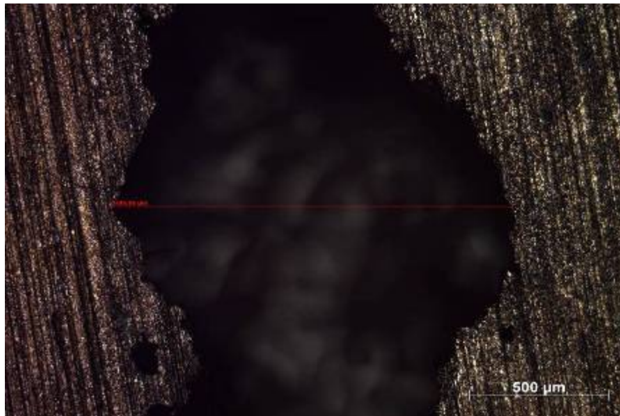
Figura 18 – Aspecto de um pite da amostra 430R.1. Tamanho aprox. 1444\mu\text{m} . (50x).
