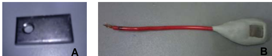
Figura 1: (A) cupom metálico para os ensaios de quantificação do biofilme e observação microscópica e (B) cupom metálico para avaliação eletroquímica.
