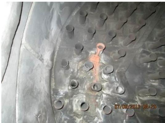
**Figura 10 - Evidência da presença de água num dos tubos selecionados para investigação com videoscópio.**
