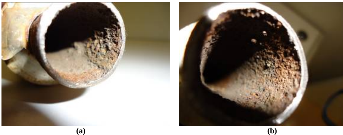
Figura 1 – Tubo antes da limpeza com muito resíduo impregnado.
