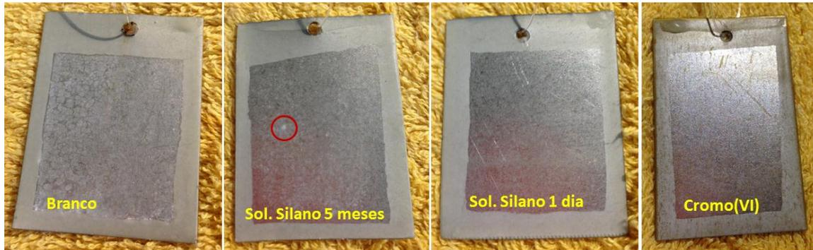
Figura 11 - Fotos das peças após 408 h de ensaio em câmara úmida para as amostras revestidas com a solução precursora após 1 dia de estocagem dessa solução para hidrólise (solução fresca) e após 5 meses de estocagem dessa solução (solução envelhecida) e para a amostra branco (sem revestimento) e para a amostra com revestimento de conversão a base de cromo(VI).
