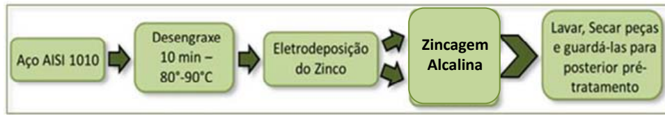
Figura 1 - Fluxograma das etapas de obtenção do aço zincado por eletrodeposição.
