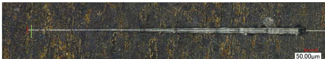
Figura 15 – Foto do ensaio de scratch test. A marca verde representa o local do deslocamento lateral de material e a marca vermelha o inicia da deformação plástica.
