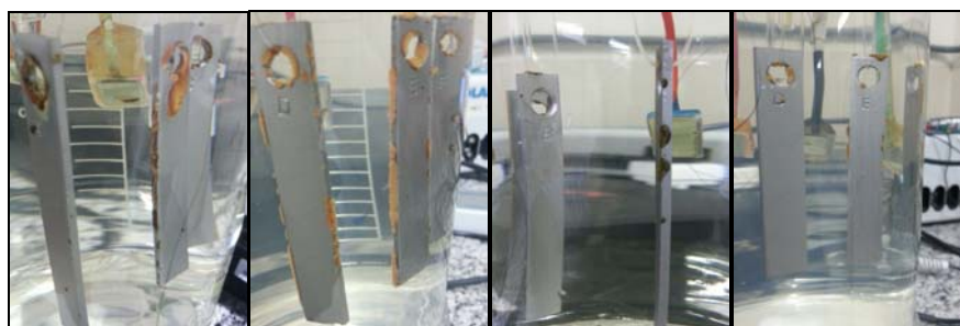
Figura 6 – Aspecto dos cupons com 72 horas de imersão em água sintética das cubas 9, 10, 11 e 12, respectivamente.
