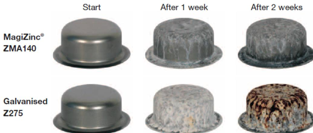
**Figura 9 - Ensaio de Névoa Salina de acordo com a norma ASTM 8117.**
