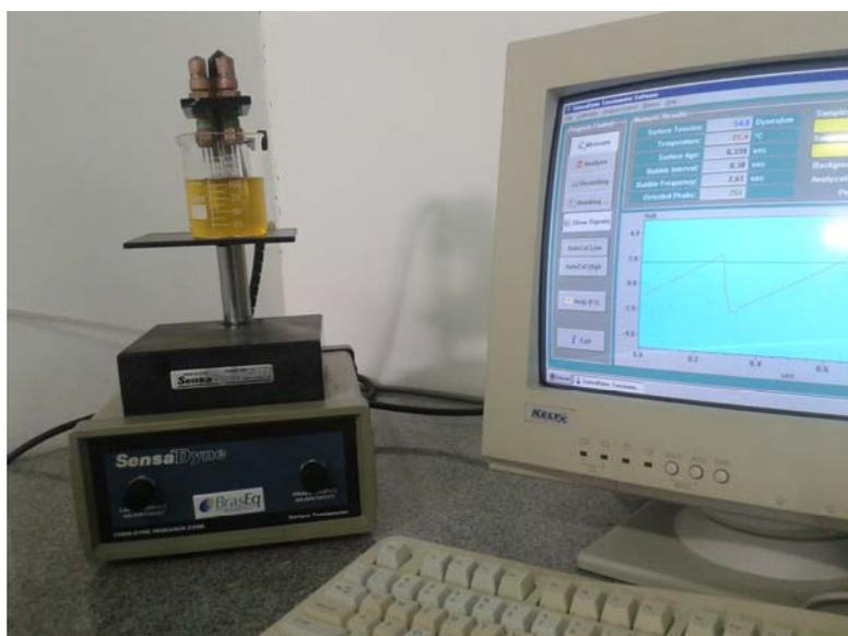
**Figura 3 – Experimento de tensão superficial de solução do tensoativo natural**
