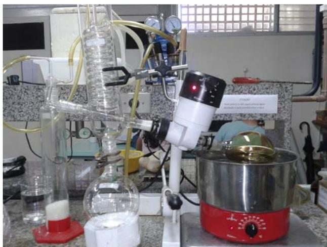
Figura 1 – Rota-evaporador
