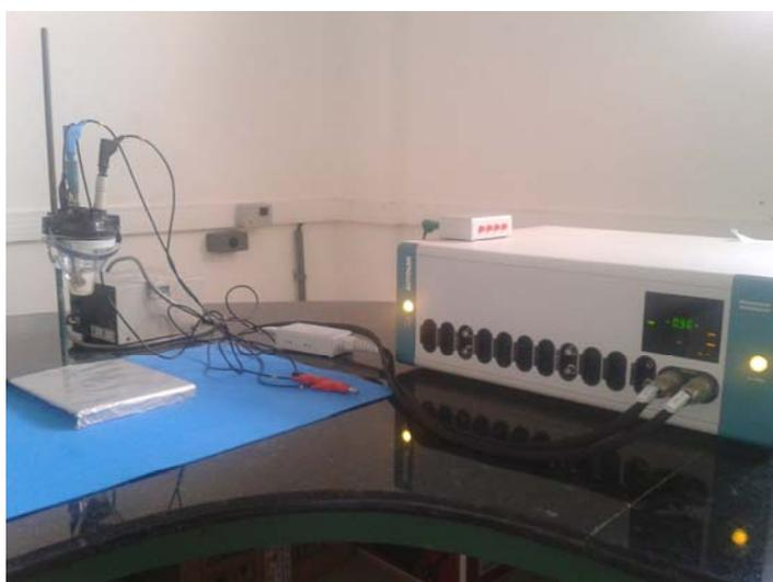
Figura 4 – Experimento de curvas de polarização em potenciostato/galvanostato
