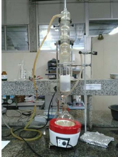
Figura 2 – Aparelho de Soxhlet
