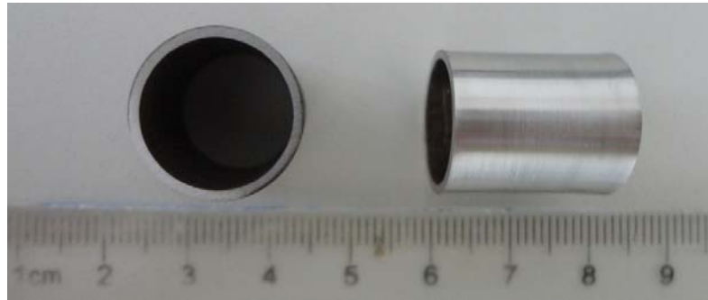
Figura 1 - Tubo de liga 800GN utilizado nos ensaios eletroquímicos
