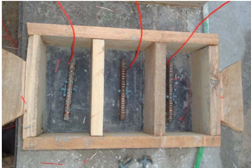
Figura 1: Imagem fotográfica da etapa de moldagem dos corpos-de-prova: barra de aço enrolada ao fio de cobre com espaçadores.
