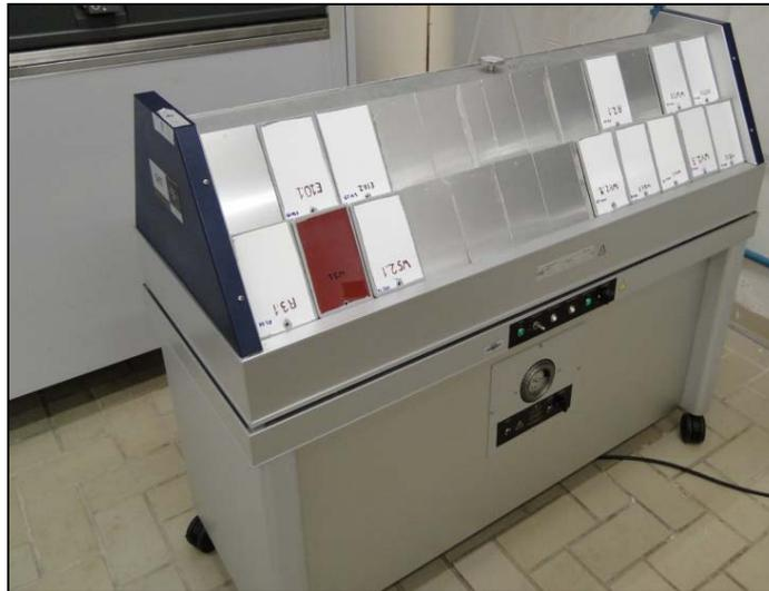
Figura 3 – Câmara de condensação de umidade.
