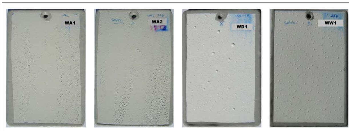
Figura 5 – Aspecto dos corpos de prova após ensaio de exposição em câmara de condensação de umidade (100% de UR, 40°C).
