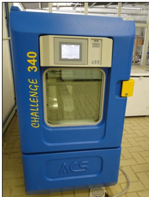
Figura 2 – Câmara de umidade utilizada no ensaio.
