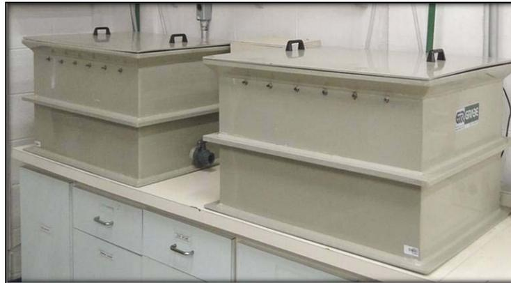
Figura 1 – Cubas utilizadas no ensaio de imersão.
