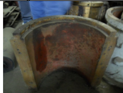
Figura 9 – Parte da proteção de um mancal de moenda.
