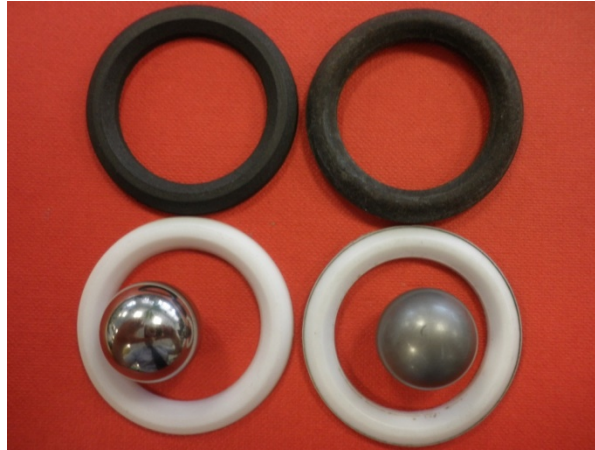
Figura 12 – Os selos e as válvulas de esfera recuperadas no êmbolo apresentam uma grande diferença na extensão de desgaste. Revestimento LT (lado esquerdo) e revestimento cerâmico (lado direito)
