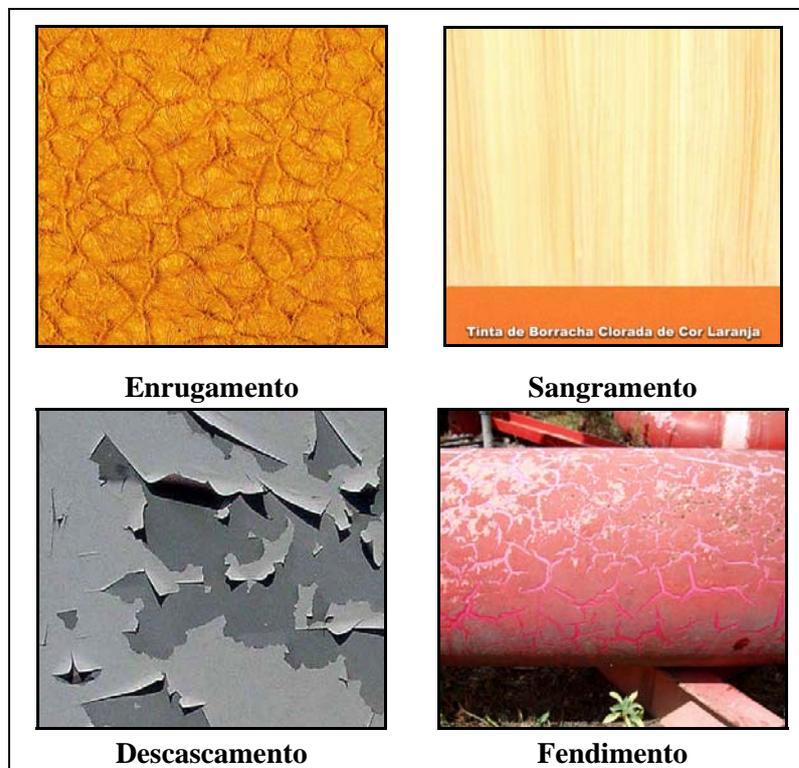
**Figura 1 – Falhas de compatibilidade entre esquemas de pintura.**
