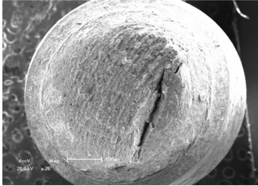
**Figura 13 - Superfície de fratura do CP ensaiado em meio de etanol de cana (25X).**
