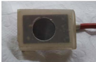
**Figura 02 – Corpo de prova utilizado em ensaio eletroquímico.**
