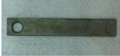
**Figura 01 – Corpo de prova utilizado em ensaio de perda de massa.**
