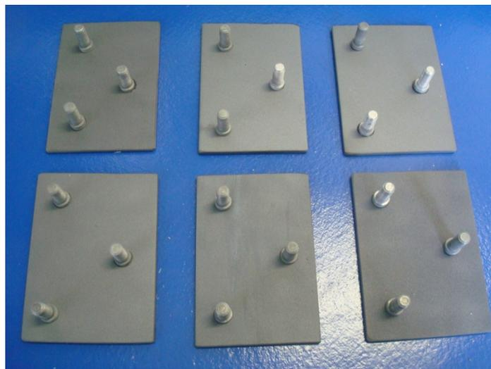
Figura 4 - Corpos de prova com os *dollyes* para a análise de aderência.
