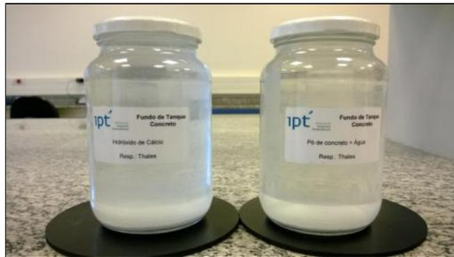
**Figura 13** - Ensaios em soluções simulando a água de poros de concreto
