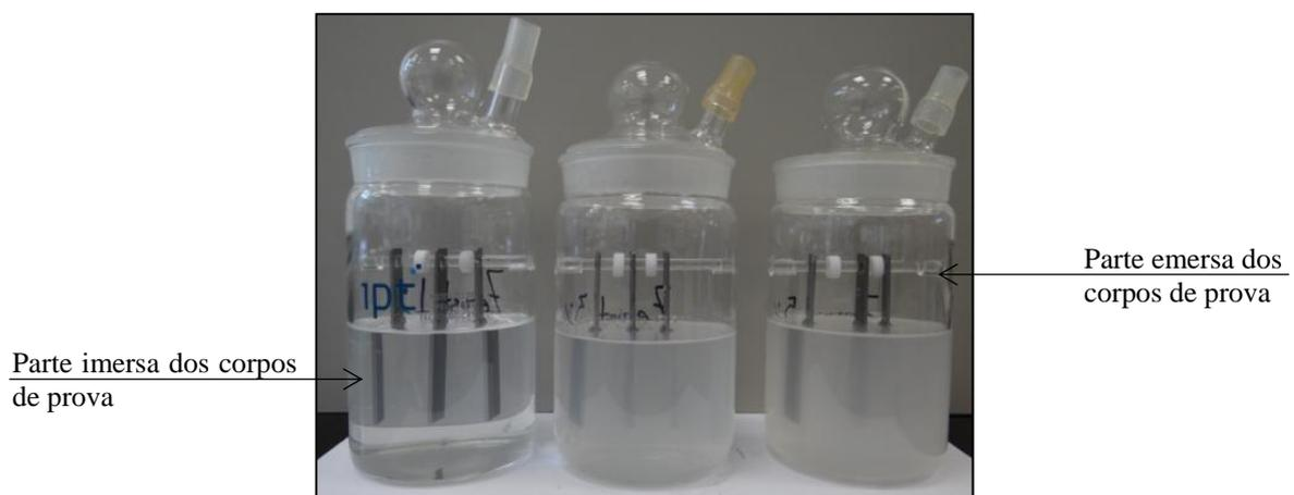
**Figura 4** - Ensaio em curso em algumas células de ensaio em solução de NaCl
