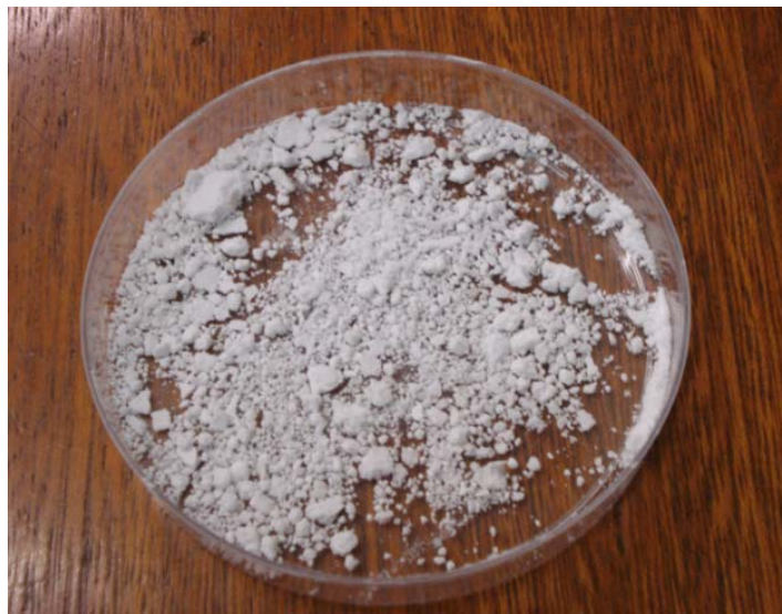
Figura 2 - Produto final (pó) obtido através do método de encapsulação por extração de solvente de uma emulsão múltipla.
