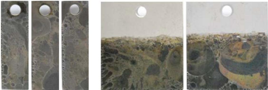
**Figura 5 – Meio: óleo combustível com 10 % de água, sem inibidor. Tempo de ensaio: 30 dias. (a) Totalmente imerso. (b) Parcialmente imerso. Não há evidências de corrosão preferencial.**
