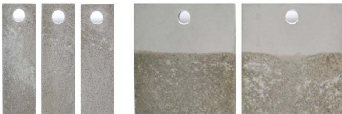
**Figura 10** – Meio: **petróleo** com 10 % de salmoura 70 mg/L de NaCl, **com inibidor**. Tempo de ensaio: **30 dias**. (a) **Totalmente imerso**. (b) **Parcialmente imerso**. Não houve corrosão preferencial.
