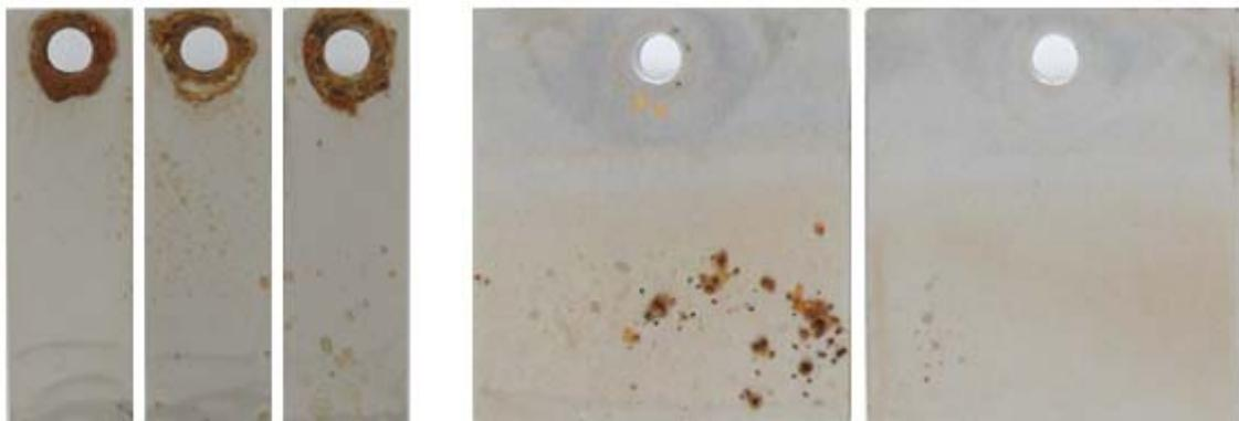
**Figura 4** – Meio: gasolina com 10 % de água, com inibidor. Tempo de ensaio: 30 dias. (a) totalmente imerso. (b) Parcialmente imerso. Não houve corrosão preferencial.
