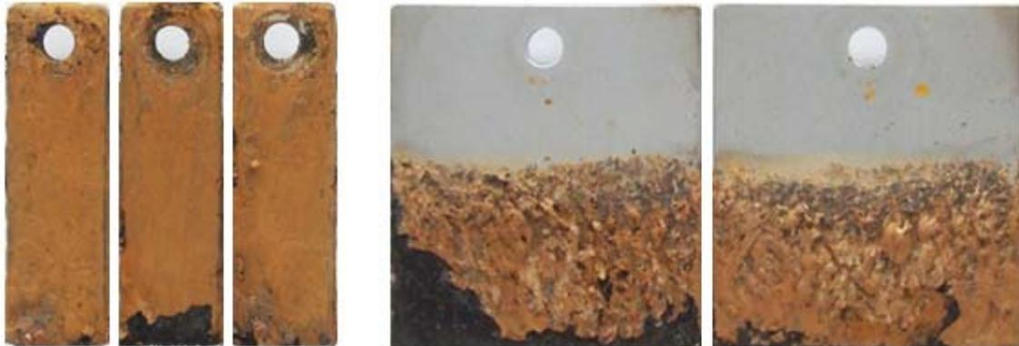
**Figura 3** – Meio: gasolina com 10 % de água, sem inibidor. Tempo de ensaio: 30 dias. (a) totalmente imerso. (b) Parcialmente imerso. Não houve corrosão preferencial.
