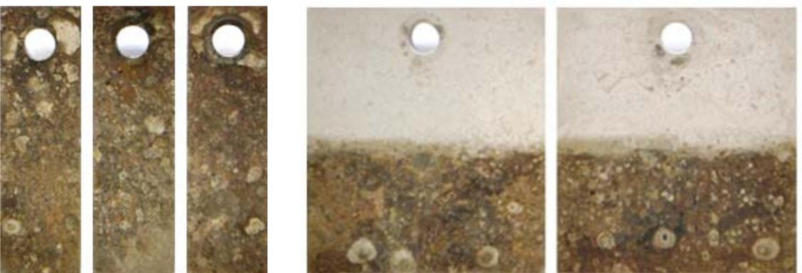
**Figura 7 – Meio: gasóleo com 10 % de água, sem inibidor. Tempo de ensaio: 30 dias. (a) Totalmente imerso. (b) Parcialmente imerso. Não houve corrosão preferencial.**
