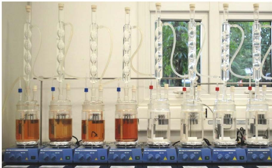
**Figura 2** – Ensaios de imersão de corpos de prova em etanol anidro e etanol PA.**Tabela 1** – Condições dos ensaios de imersão. Tempo de ensaio 30 dias
