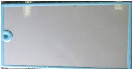
TPO-6784/1 W-Zn Novo I + 10005650 Epóxi HB
