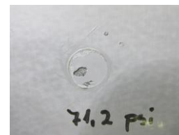
Figura 15 – Foto do ensaio Aderência ( Pull-Off Test ), TPO-6784/1 W-Zn Novo I + 10005650 Epóxi HB
