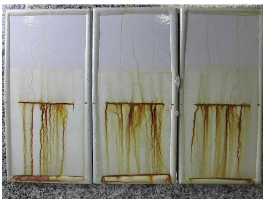
Figura 2 – Foto do ensaio Cíclico de Corrosão I, 5 ciclos, TPO-6784/2 W-Zn Novo II + 10005650 Epóxi HB
