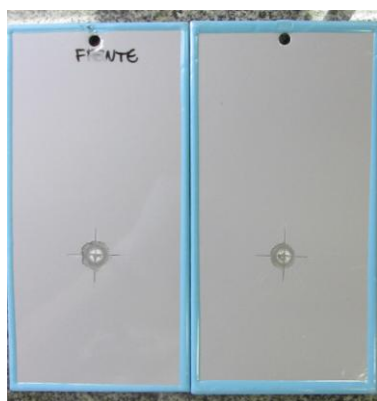
Figura 10 – Foto do ensaio Descolamento Catódico, TPO-6784/2 W-Zn Novo II + 10005650 Epóxi HB
