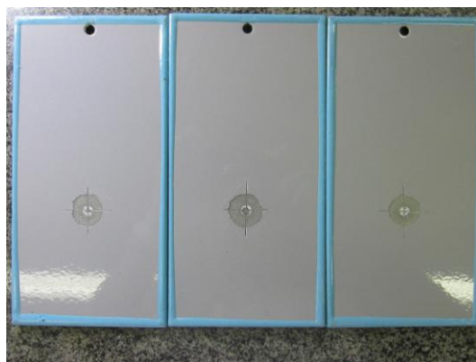
Figura 9 – Foto do ensaio Descolamento Catódico, TPO-6784/1 W-Zn Novo I + 10005650 Epóxi HB
