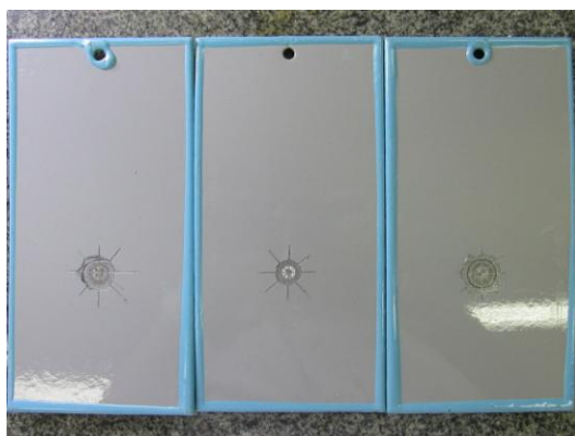
Figura 12 – Foto do ensaio Descolamento Catódico, TPO-6784/2 W-Zn Novo II+TPO-7468/1 Poliéster HB
