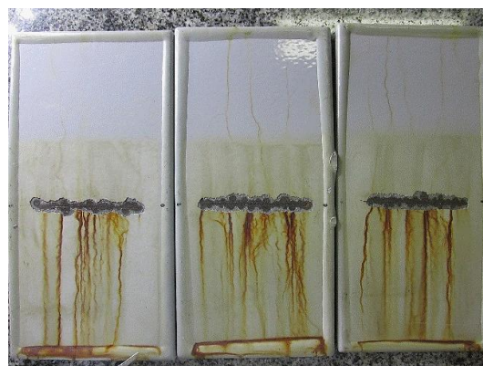
Figura 2 – Foto do ensaio Cíclico de Corrosão I, 5 ciclos, TPO-6784/2 W-Zn Novo II + 10005650 Epóxi HB
