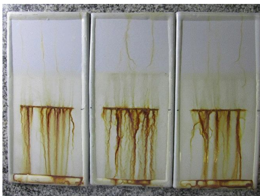
Figura 1 – Foto do ensaio Cíclico de Corrosão I, 5 ciclos, TPO-6784/1 W-Zn Novo I + 10005650 Epóxi HB
