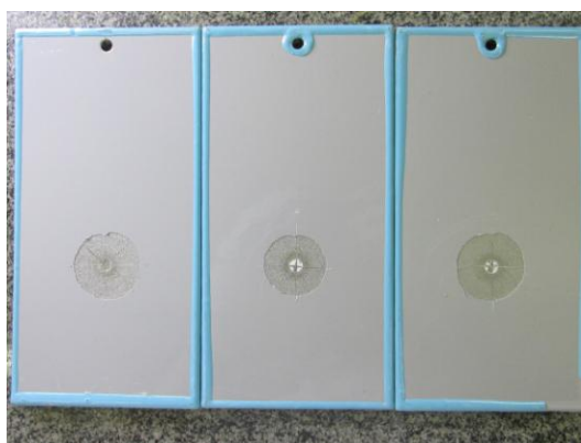
Figura 11 – Foto do ensaio Descolamento Catódico, 10005667 W-Zn + TPO-7468/1 Poliéster HB
