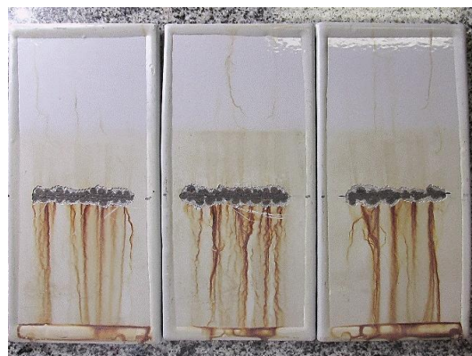
Figura 1 – Foto do ensaio Cíclico de Corrosão I, 5 ciclos, TPO-6784/1 W-Zn Novo I + 10005650 Epóxi HB
