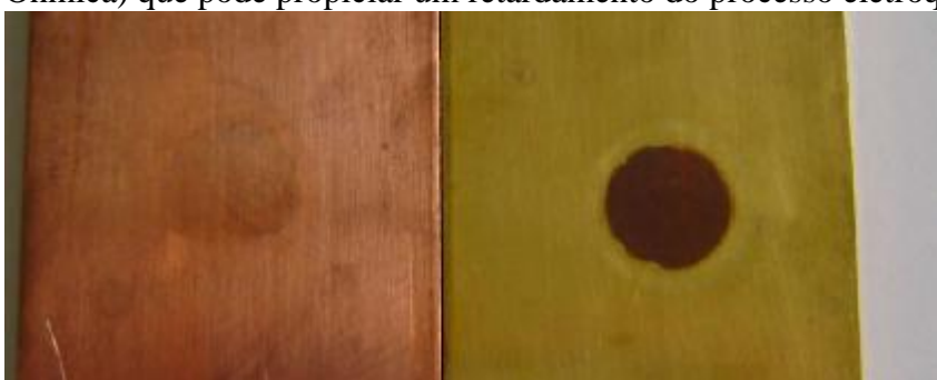
Figura 4 - Sinais de oxidação seletiva no latão.
