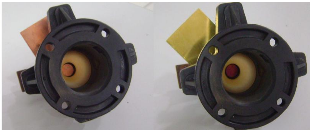
Figura 2 - Célula eletroquímica, ora com a liga de cobre 144, ora com o latão.
