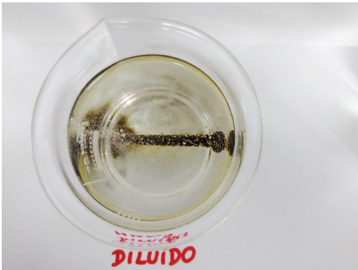
Figura 2 – Intensa formação de bolhas durante o processo corrosivo do prego.
