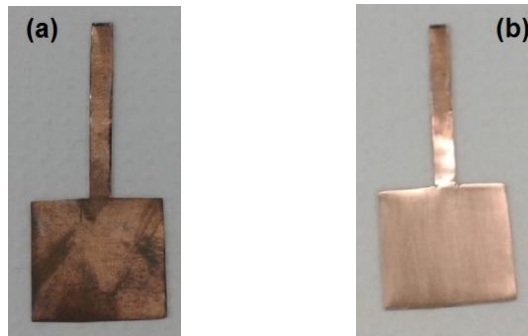
Figura 1 – Substrato de cobre (a) antes e (b) depois do polimento com lixas
