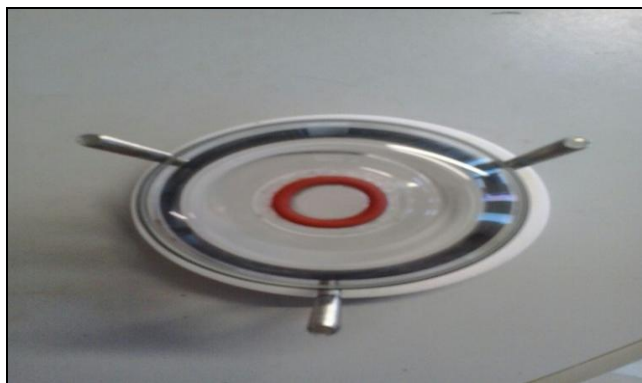
Figura 3 - Parte posterior da célula eletrolítica/ Orifício circular onde o corpo de prova fica exposto.
