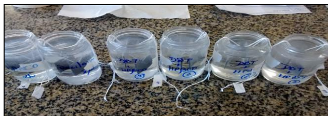
Figura 1 – Ensaio de perda de massa em HCl 1 \text{ mol L}^{-1} , contendo duplicatas de corpos de prova em cada ensaio.
