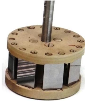
Figura 1 – Esquema típico da GR e distribuição dos corpos de prova.
