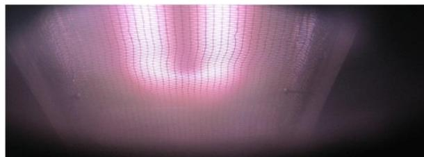
**Figura 1 - Recobrimento, plasma ativo no magnetron**
