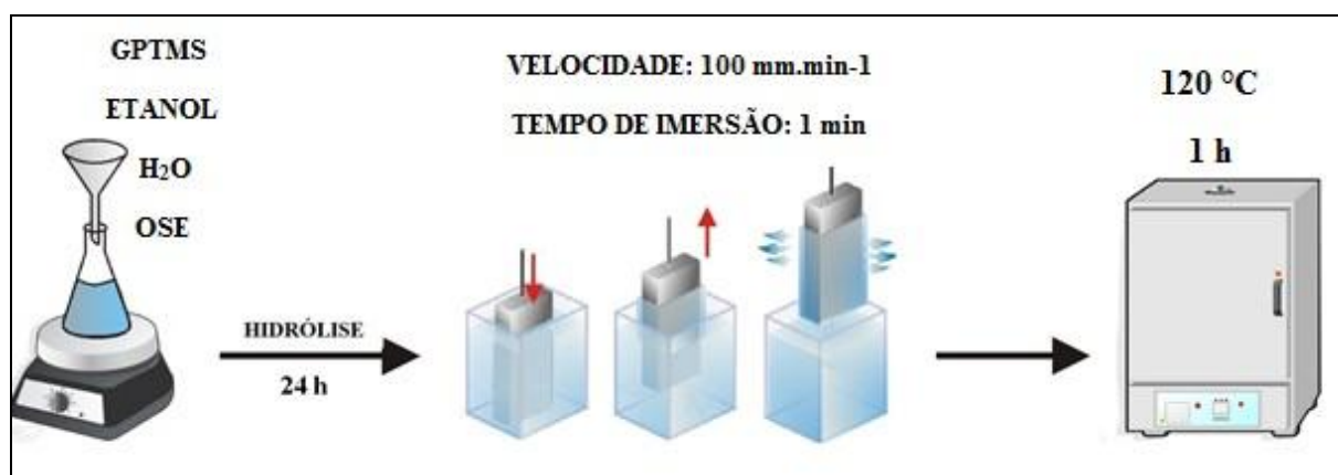
Figura 1- Esquema ilustrativo dos parâmetros experimentais utilizados na síntese dos filmes e das etapas do processo de dip coating
