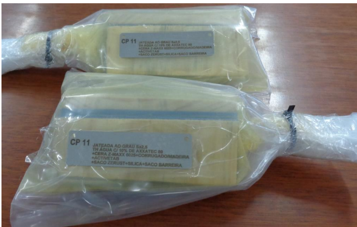
Figura 4 – Imagem dos corpos de prova da amostra CP11 após a realização do ensaio de corrosão cíclico.
