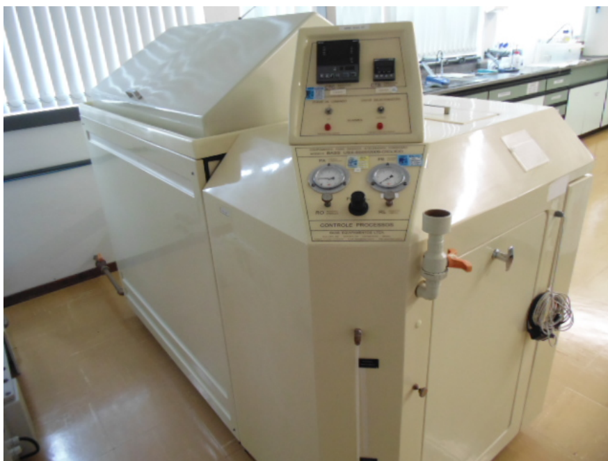
Figura 1 – Câmara cíclica utilizada para execução do ensaio cíclico.
