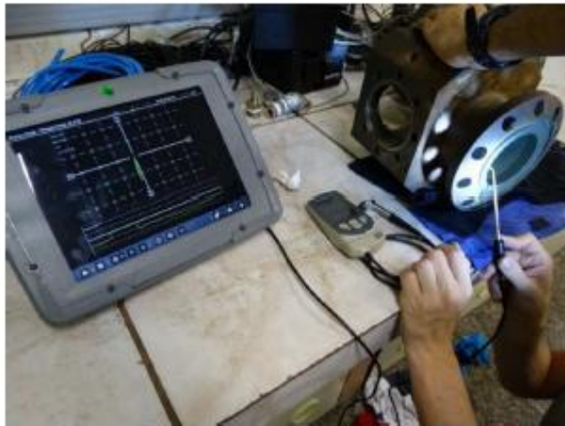
Figura 14 - Inspeção da válvula V3 via correntes parasitas.
