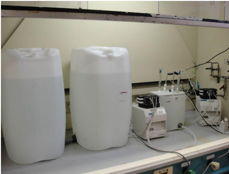
Figura 2 - Esquema do ensaio montado para os testes de potencial x tempo em água do mar natural realizados, com vazão de 16mL/min (22,8 L/dia).
