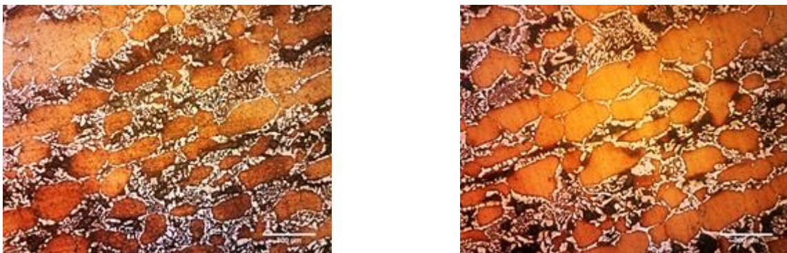
Figura 6 - Microscopia óptica do aço superduplex UNS S32750 tratado termicamente por 2h (a) e por 3h (b) Microscopia ótica, obtidas pelo ataque com reagente Behara, com o aumento de 200X.
