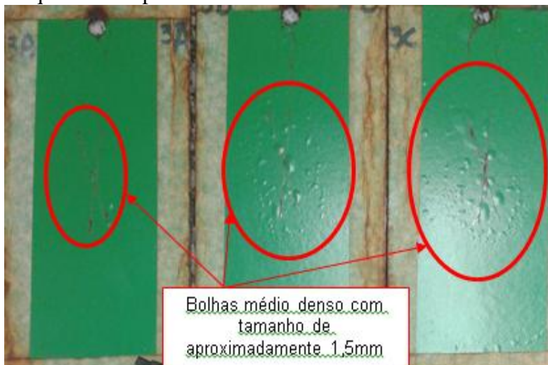
Figura 8 - Amostras expostas a 528 horas em câmara de névoa salina para amostras com fosfato de ferro.
