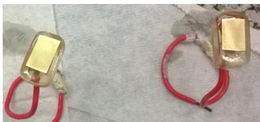
**Figura 3 – Corpos de Prova revestidos com Resina Epoxídica**
