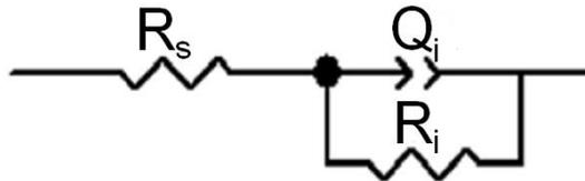
**Figura 3 – Circuito elétrico equivalente utilizado para ajustar os diagramas de EIS da Fig. 1.**
