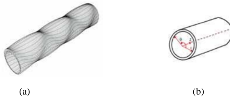
Figura 5- (a) Representação da propagação do modo Flexural. (b) Destaque em vermelho dos deslocamentos do modo Flexural ( u_r , u_z , u_\theta ).
