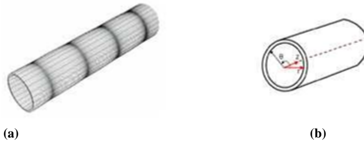
Figura 3- (a) Representação da propagação do modo longitudinal ou de compressão. (b) Destaque em vermelho dos deslocamentos do modo longitudinal ( u_r , u_z ).
