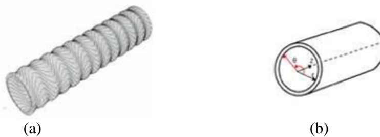
Figura4- (a) Representação da propagação do modo Torsional. (b) Deslocamento do modo Torsional ( u_\theta ) (Destaque em vermelho).
