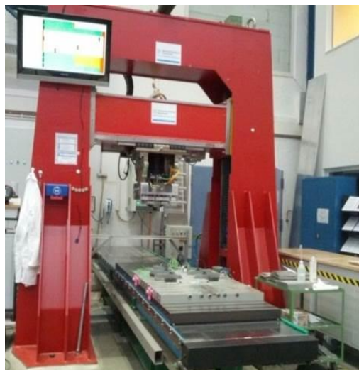
Figura 1 - Equipamento utilizado para a soldagem FSW
