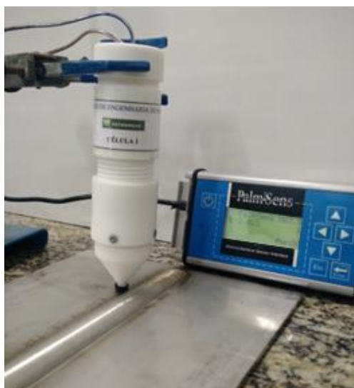
Figura 4 - Ensaio ERP-DL em soldas FSW.
