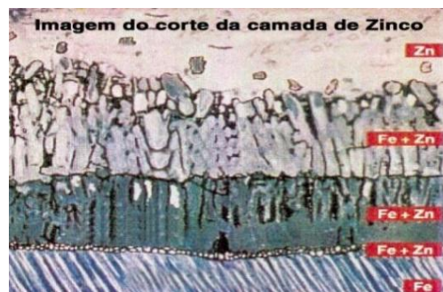
Figura 2 - Imagem do corte da camada de Zinco sobre o aço após galvanização.
