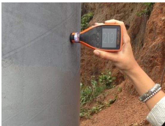
Figura 6 – Medidor de espessura de camada de revestimento de zinco sobre o substrato de aço.
