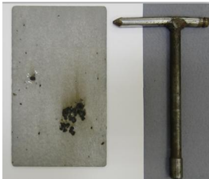
Figura 1 - Ferramenta manual utilizada para a retirada de produto de corrosão de aço carbono.
