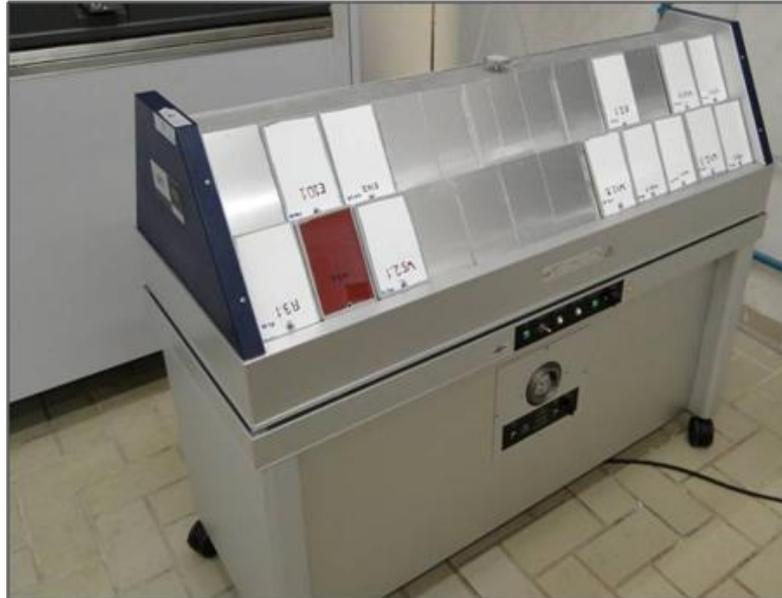
Figura 3 - Câmara de condensação de umidade, com os corpos de prova revestidos.
