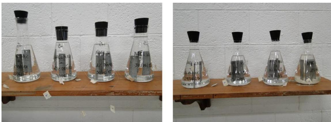
Figura 2 - Placas de aço carbono (à direita) e zinco (à esquerda), imersas em solução de NaCl 3,5%, para o ensaio de perda de massa.
