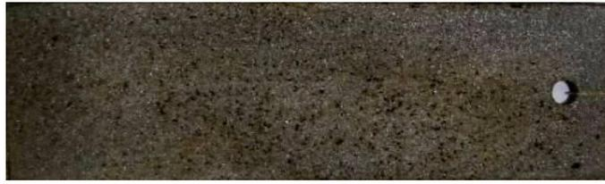
**Figura 4 - Placa de aço carbono submetida ao ensaio de em perda de massa com presença de bórax, na concentração de 1%.**
