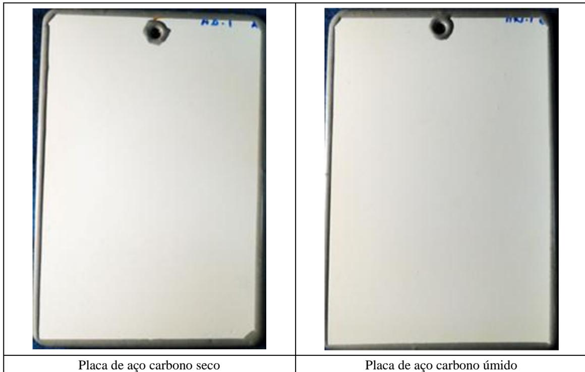
**Figura 15- Placas de aço carbono, seca e úmida, após 744h de ensaio na câmara de condensação de umidade.**
