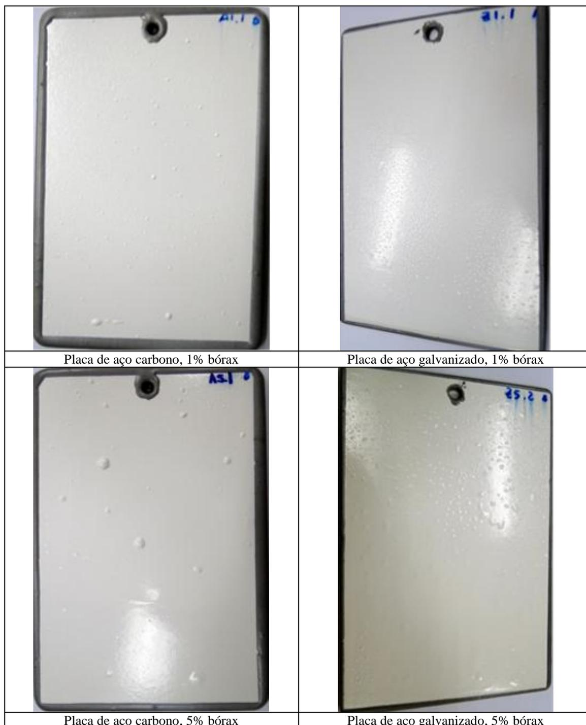
Figura 13 - Corpos de prova ensaiados em câmara de condensação de umidade após 48h de ensaio.
