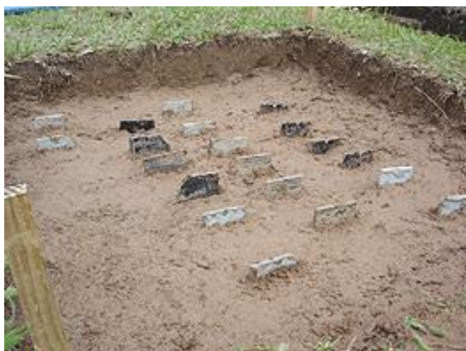
Figura 6 – Corpos-de-prova enterrados para o ensaio no terreno do Cepel.
