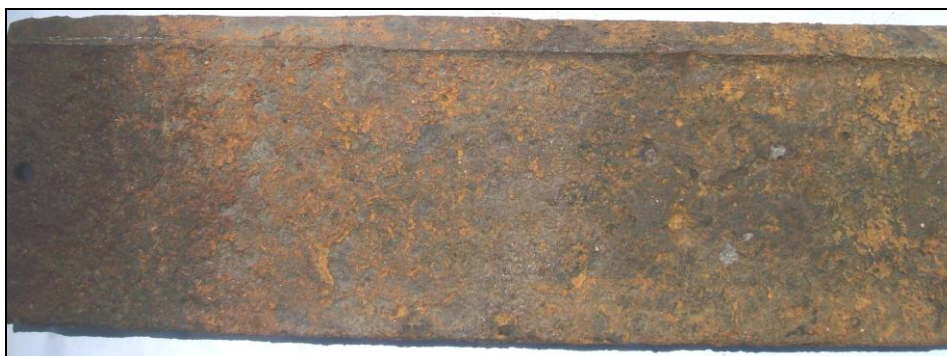
Figura 13 – Aspecto da chapa de grau D, preparada por meio de jateamento abrasivo úmido e enterrada diretamente no solo do CEPTEL por 15 meses, sem qualquer sistema de proteção.
