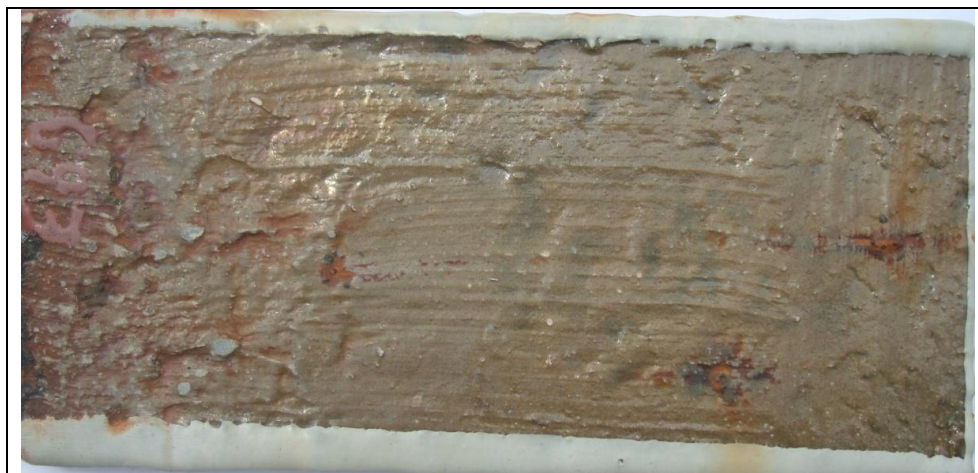
Figura 8 - Aspecto do corpo-de-prova revestido com o sistema E6 após 4128 horas de imersão em solução de NaCl 3,5%, a 40°C.
