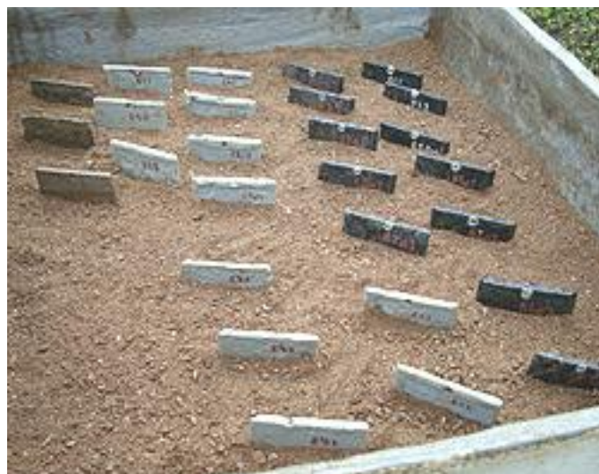
Figura 5 – Corpos-de-prova que foram enterrados para o ensaio em solo úmido e no solo úmido com cloreto de sódio.
