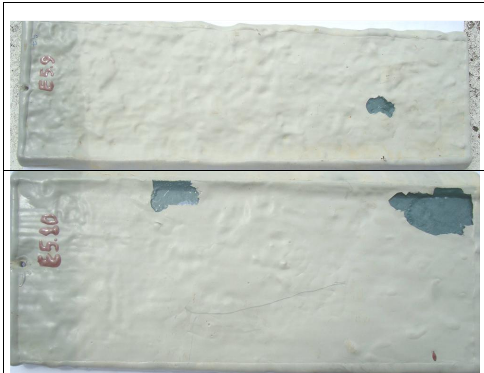
Figura 7 - Aspecto dos corpos-de-prova revestidos com o sistema E5 após 4128 horas de imersão em solução de NaCl 3,5%, a 40°C.
