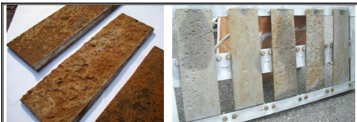
Figura 1 – Chapas de aço galvanizado, antes e após o tratamento de superfície.
