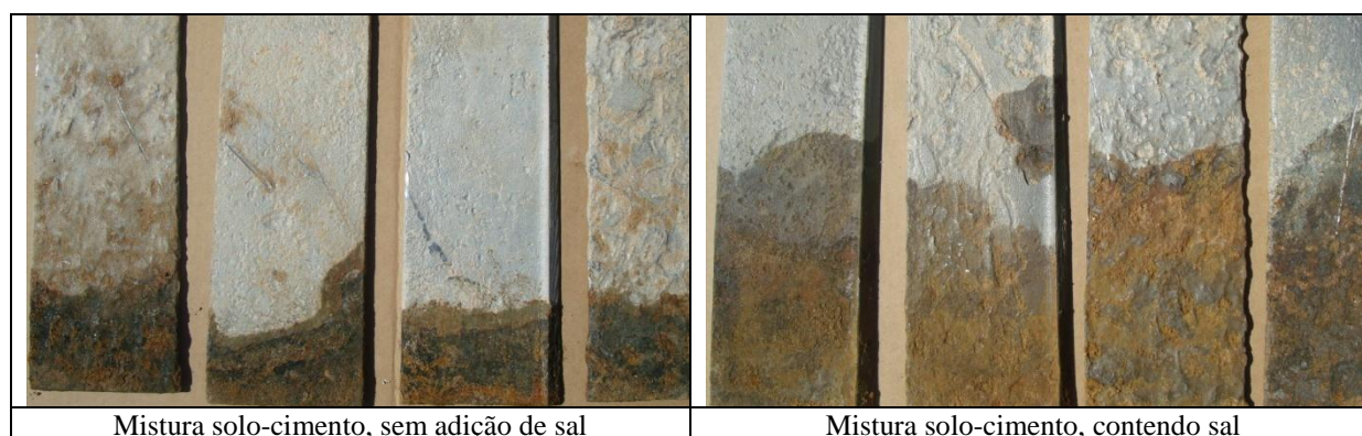
Figura 12 – Aspecto dos corpos-de-prova imediatamente à retirada do ensaio.
