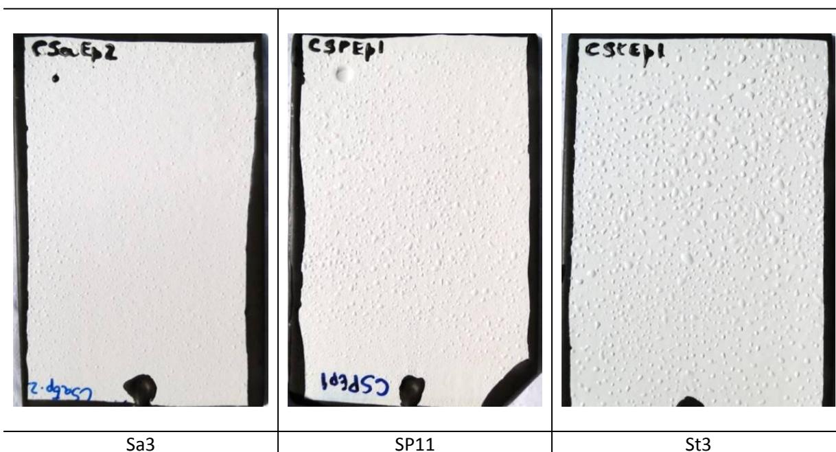
**Figura 3 - Aspecto dos corpos-de-prova ao final do ensaio de exposição em câmara de condensação de umidade (100% UR, 40 °C).**
