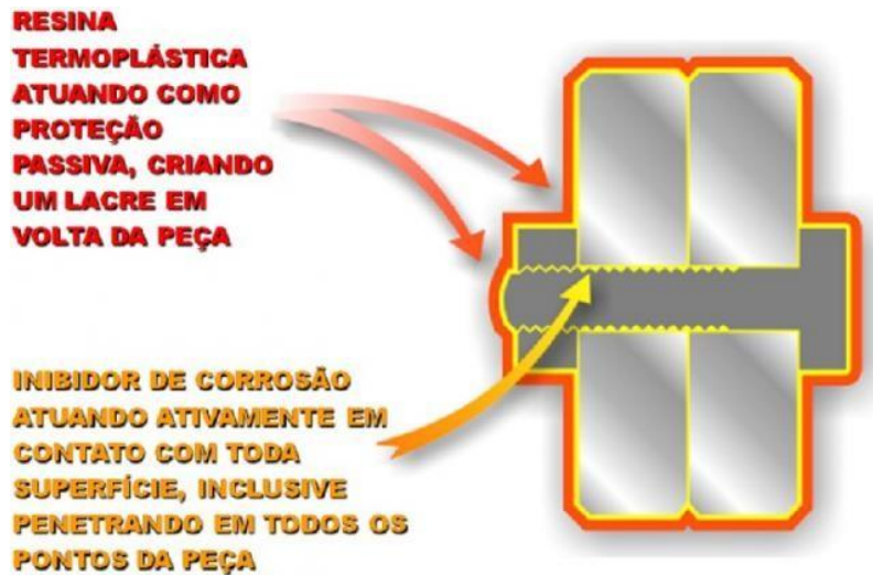
Figura 4: Demonstração do princípio de funcionamento do polímero termoplástico.
