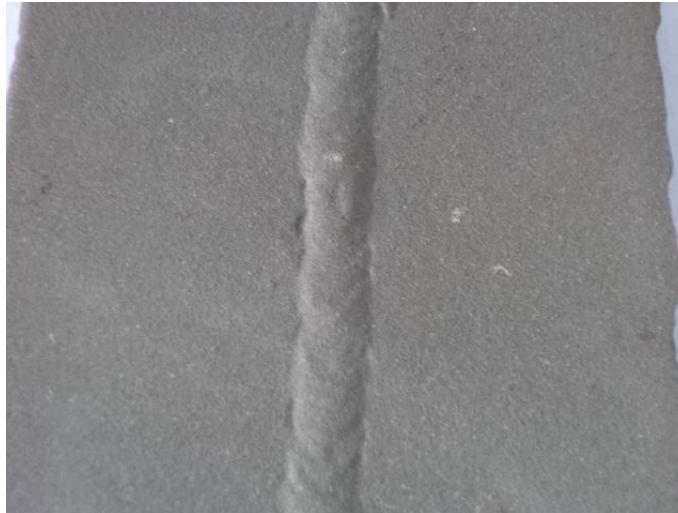
Figura 08 – Corpo de prova – 10 meses preservado com inibidor
