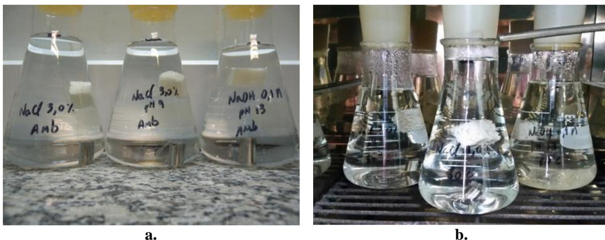
**Figura 7: Espuma de PU imersas em soluções de NaCl 3% pH 7, NaCl 3% pH 9 e NaOH 0,1M pH 13:**
