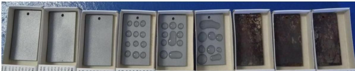
**Figura 9:** Da esquerda para a direita: superfície tratada e seca (3 cps), superfície tratada e úmida (3cps) e superfície sem tratamento (3 cps).
