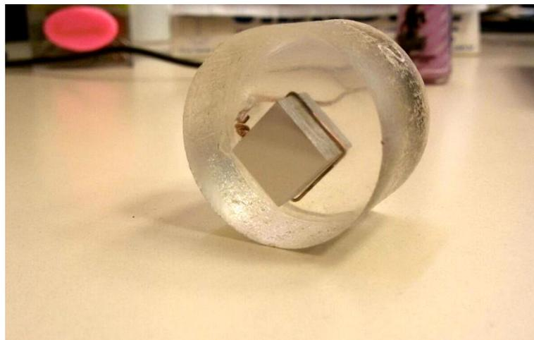
**Figura 3 - Amostra com acabamento final para o ensaio eletroquímico.**
