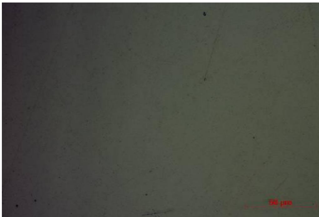
Figura 5 - Aspecto superficial do Inox AISI 316 lixado e polido (amostra 2) em imersão à quente, durante 30 minutos.
