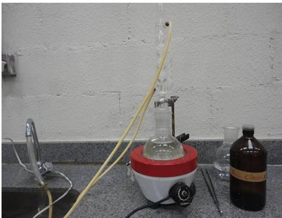
Figura 2 - Equipamento utilizado para os ensaios de imersão à quente.
