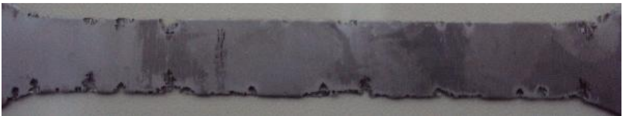
Figura 16 - Corpo de prova AISI 430 R 19 10 após ensaio.
