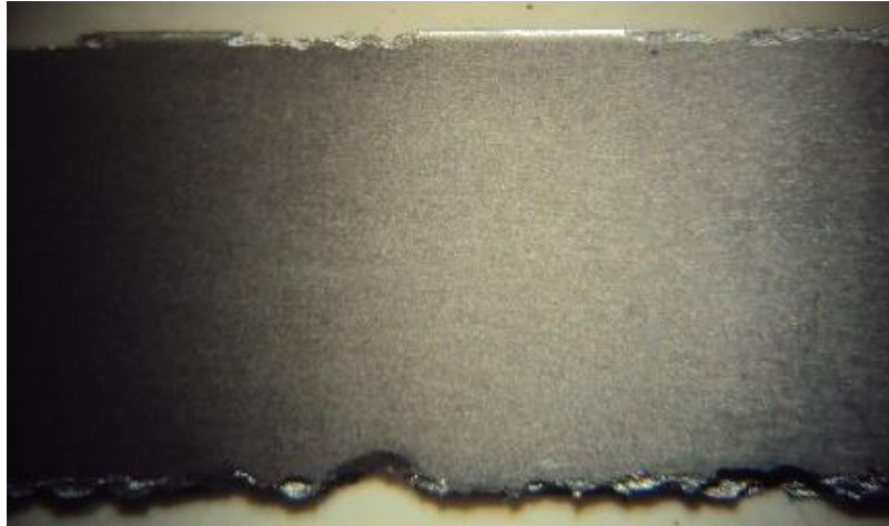
Figura 5 - Corpo de prova AISI 430 B 1 03 após ensaio.
