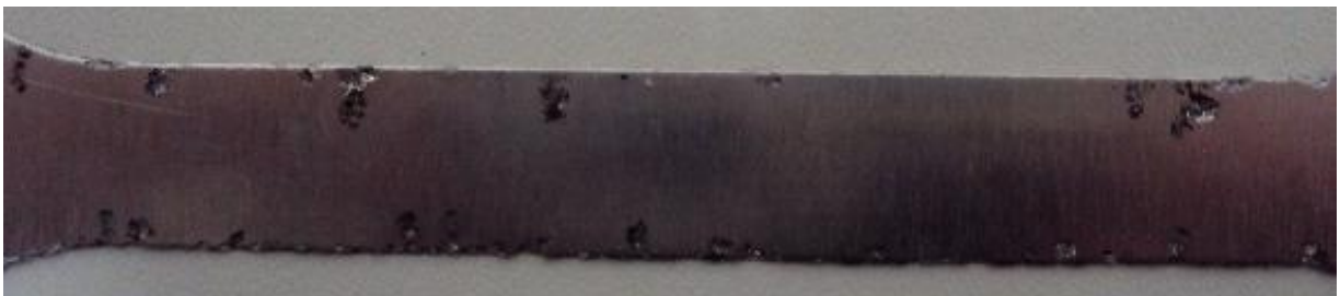
Figura 9 - Corpo de prova AISI 439 R 8 03 após ensaio.
