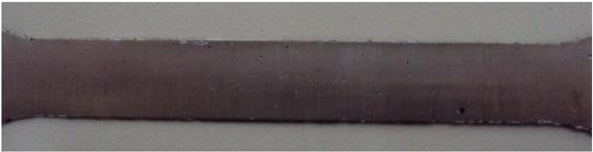
Figura 8 - Corpo de prova AISI 439 E 5 03 após ensaio.
