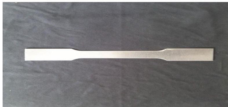
Figura 2 - Aspecto de um corpo de prova utilizado nos ensaios.
