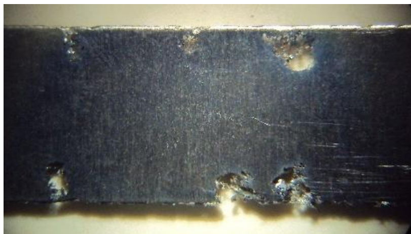
Figura 19 - Corpo de prova AISI 439 R 23 10 após ensaio.
